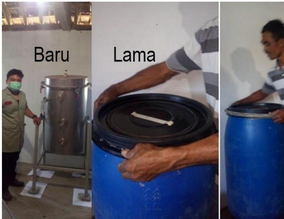
Gambar 3. Fermentor baru (*scale up*) dan lama
